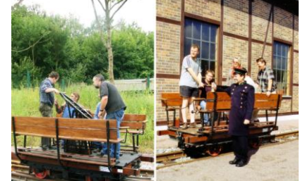
Aus einem alten Feldbahnfahrzeug aus dem Jahre 1920 entsteht eine Handhebeldraisine für die AG Verkehrsgeschichte Wilsdruff.
